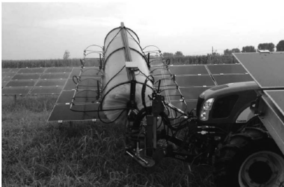
Zdjęcie nr 20. Mycie paneli fotowoltaicznych za pomocą specjalnej dostawki do ciągnika rolniczego.
