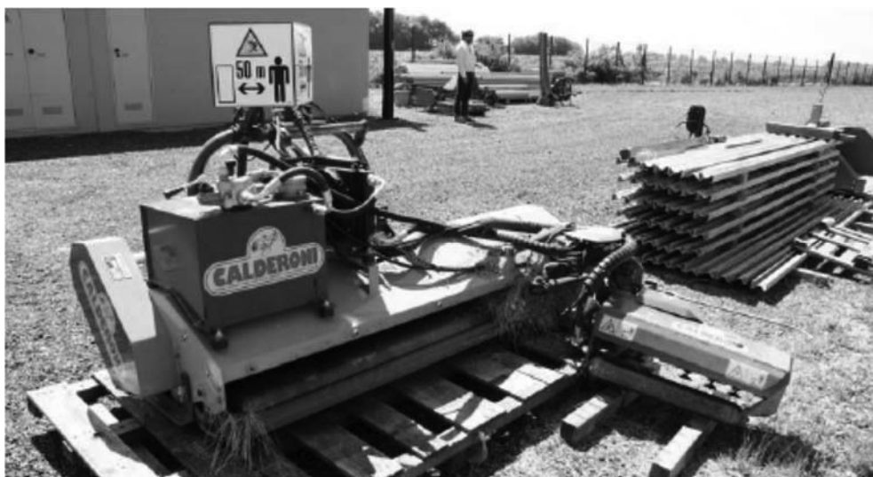
Zdjęcie nr 19. Dostawka do ciągnika rolniczego służąca do wykaszania terenu instalacji odnawialnego źródła energii paneli fotowoltaicznych.
