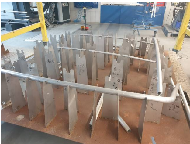
Fot. 15 Przykładowe detale produkowane przez Inwestora przeznaczone do malowania proszkowego i elektropolerowania.
