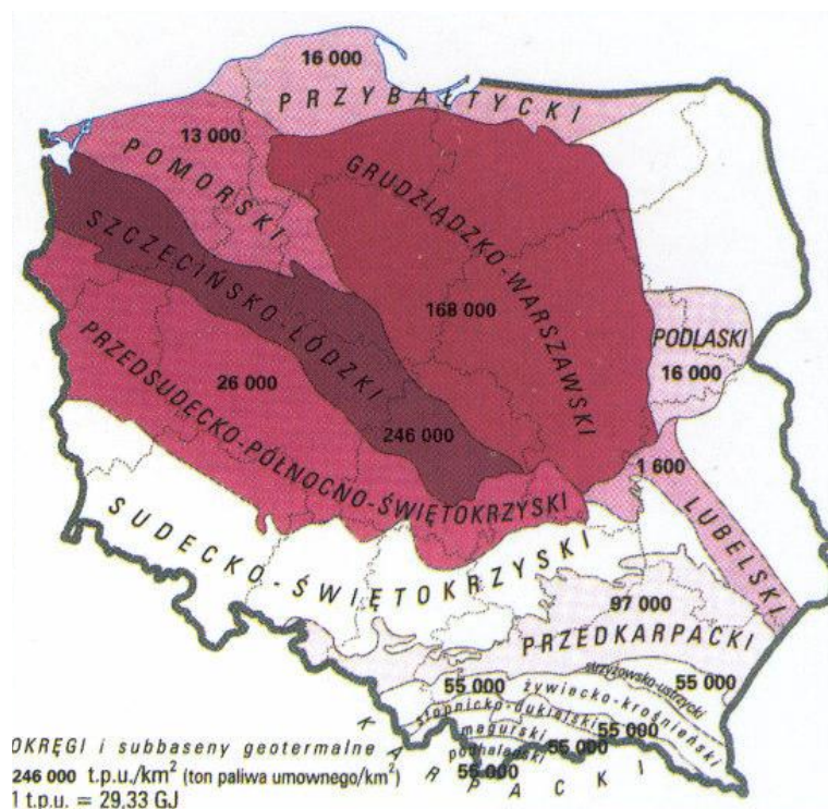
Rysunek 14. Potencjał energii geotermalnej z uwzględnieniem okręgów i subbasenów
